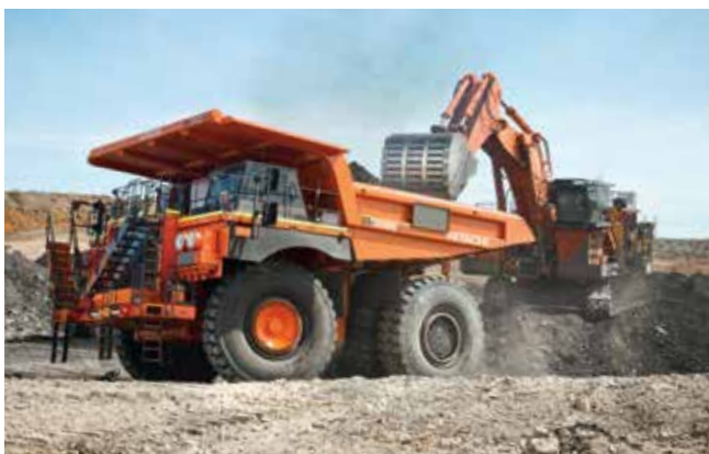
Dúmpers rígidos EH y excavadoras gigantes EX
