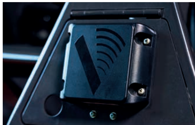
El sistema de detección de obstáculos traseros mejora la seguridad en el lugar de trabajo.
