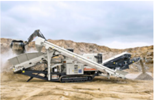
La Lokotrack® LT200HPS™ puede contar con cribas desmontables tanto de una como de dos camas.
