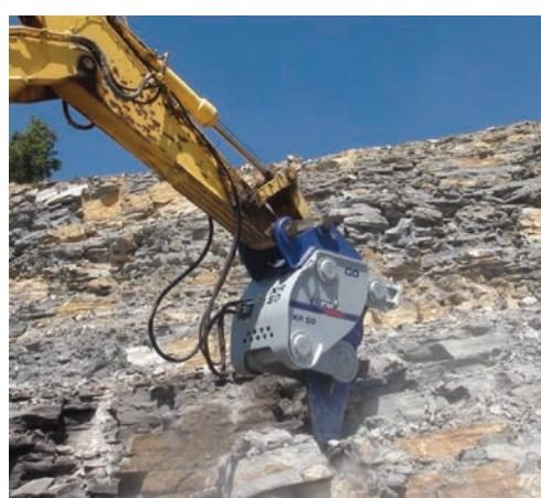
La estanqueidad de la cámara de energía del Xcentric® Ripper imposibilita que el polvo, el agua, la suciedad o cualquier otro elemento exterior pueda dañarla. Esto significa que se puede trabajar en las condiciones más severas y sin ningún problema en túneles, movimiento de tierras y lugares embarrados y húmedos.
